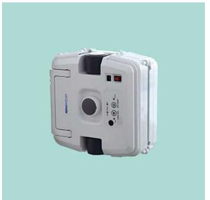
Windowmate は、2 台の機械で窓をはさみ、自動で拭き掃除を行う窓拭きロボットです。2 台の機械には永久磁石（ネオジム磁石）を内蔵しており、電源が切れても落下しない設計になっています。Haneda Robotics Lab では、まずはターミナルビル内の室内空間におけるガラス面の清掃作業が安全かつ効果的に行えるかを検証します。また、安全性が十分に検証された場合、ターミナルビルの外面、高所作業などについても対応
