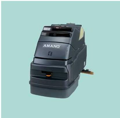
SE-500iX II は、無人で床面を洗浄（水洗い）できる自律走行方式のロボット床面洗浄機です。あらかじめ手動操作した作業を記憶させると、同じ作業を自動運転で再現することができます。Haneda Robotics Lab では、空港内の洗浄作業と磨き作業について、人による機械操作と比べた SE-500iX II の洗浄面積、時間、洗浄・磨きの品質といった視点から効率化の度合いを確認します。また、将来的に SE-500iX II が多数の空港利用者さまが行き交う公共空間において、安全に自律走行をしつつ清掃作業を行うことを目標とした、初期の検証を行います。
