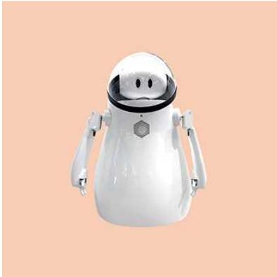
CAIBA（カイバ）は遠隔操作型ロボットです。インターネット接続されたロボットは、遠隔地でも操縦者の動きを正確にトレースし、まるで操縦者の分身のように振る舞うことができます。Haneda Robotics Labでは、CAIBA 自身がお客様を目的地までご案内するなどの業務が的確に行えるかを検証します。これらの用途価値検証を行うことで、将来的に様々な空港従業員（在宅勤務、高齢者、身体障害者等）が広く空港業務に従事し続
