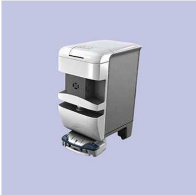
TUG は自律型搬送ロボットです。高度なセンシング技術を駆使した高い機動性と安全性を兼ね備えており、広いフロアを自由に行き来できます。TUG には 2 種類のタイプがあり、ボックスタイプは指紋認証や ID・パスワード認証で扉の開閉を制限できるため、現在は米国の病院などで薬品や検体の搬送に利用されており、リフトタイプは給食、リネン、廃棄物搬送に利用されています。Haneda Robotics Lab では、まずは空港従
