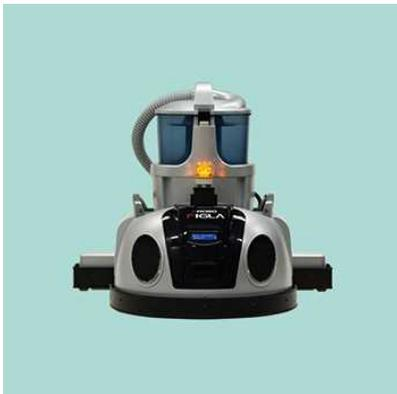
エフロボクリーンは、自律走行方式の業務用清掃ロボットです。各種センサーを複合的に組み合わせて、周囲環境を認識しながら自動で清掃を行います。人による清掃作業が困難な暗い場所などで使用でき、標準の仕様で1時間あたり300～650㎡(実働)の作業が可能です。Haneda Robotics Labでは、新たに追加した周囲に存在を示す大型回転灯や、メロディ機能などの実際の効果を検証しつつ、将来的に空港利用者さまが行
