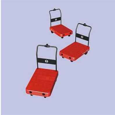
CarriRo（キャリロ）は、作業員の負荷を軽減するドライブモード、作業員を自動で追尾するカルガモモードを搭載した台車型物流支援ロボットです。Haneda Robotics Lab では、まずは空港従業員の業務活用として、物販店舗への商品搬入作業やその他業務への用途価値検証を行います。また、将来的に空港利用者さまのお荷物の搬送補助などへの活用も視野に入れた初期の検証を行います。
