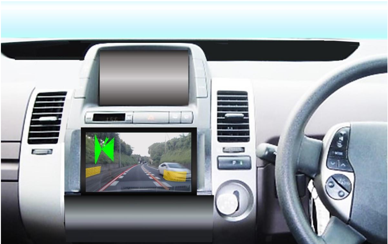
IZAC が将来 2DIN サイズに収まったときの車内取り付けと表示画面イメージ レーン検出やレーザーセンサーの検知結果を表示しています
