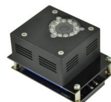
屋内位置検出システム
