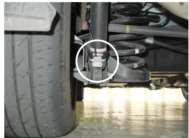
<サスペンションへのセンサ取り付け例>
