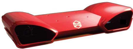
<ソニー製 CMOS センサを用いたステレオカメラ RoboVision2>
