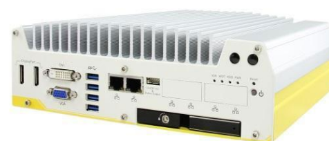
車載コンパクトファンレス PC Nuvo-5100VTC 外観
