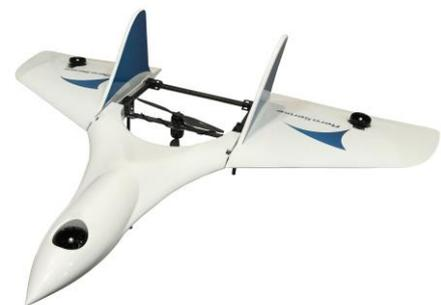
エアロセンス社製 自律飛行・垂直離着陸型の固定翼ドローン (VTOL)
