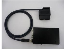
OBDII専用ケーブルにて車のOBDIIコネクタに接続
